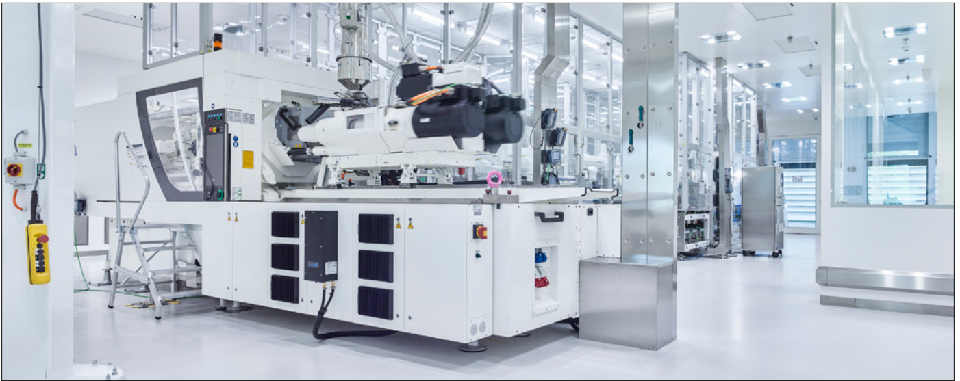
Innenansicht aus dem Reinraum-Produktionsbereich mit Spritzgiessmaschine bei Schott Pharma Müllheim.
