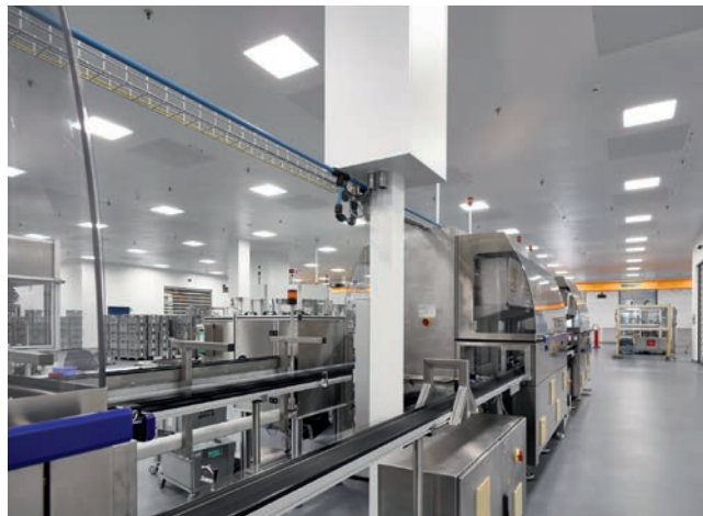
Bild 1. Reinraum: Nach der Herstellung der Kunststoffkomponenten und der hochautomatisierten Montage werden die Produkte verpackt, palettisiert und sterilisiert
